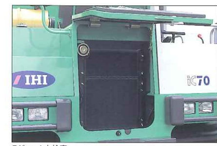
ラジエータ点検窓
