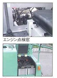
バッテリー点検カバー
