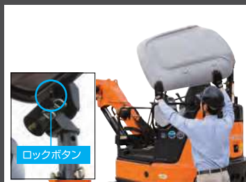
2. キャノピを45° 傾けると、一旦ロックします。 ボタンを押してロックを解除します。
